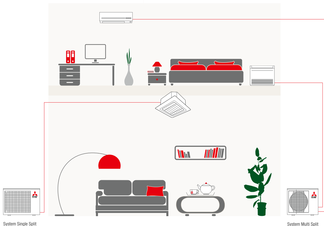
Instalacje Single Split i Multi Split
